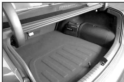
«Умный» багажник имеет функцию открытия без помощи рук, при этом владельцу даже не нужно делать никаких жестов – достаточно приблизиться к багажнику, имея при себе брелок, и подождать три секунды, после чего крышка багажника откроется автоматически. Объем багажника – 510 литров, что почти на десять процентов больше, чем у модели предыдущего поколения.
