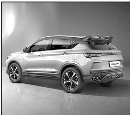
Габариты обновленного Geely Coolray не изменились. Они как и раньше укладываются в субкомпактный класс «K1»: длина составляет 4330 мм, ширина – 1800 мм, высота – 1609 мм. При этом колесная база насчитывает 2600 мм, а дорожный просвет достигает 190 мм.
