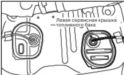
3. Отсоединить электрический разъем топливного насоса и датчика уровня топлива.
