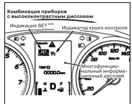
3. Повторно нажать на переключатель ON/OFF круиз-контроля и убедиться, что соответствующий индикатор на комбинации приборов выключился (стандартная комбинация приборов) или отключилось рабочее окно системы круиз-контроля на многофункциональном информационном дисплее комбинации приборов (комбинация приборов с высококонтрастным дисплеем).
