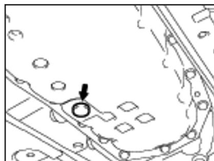
2. Установить сливную пробку вместе с прокладкой в отверстие картера вариатора и затянуть пробку с установленным моментом. Момент затяжки: 34,3 Н·м. Издательство «Монолит»
