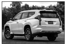
По сравнению с Pajero Sport предыдущего поколения ширина, высота и колесная база остались прежними: 1815 мм, 1800 мм и 2800 мм соответственно. Длина увеличилась на 40 мм — до 4825 мм. Автомобиль обладает внушительными параметрами геометрической проходимости: 218 мм дорожного просвета, угол въезда — 30 градусов, съезда — 24 градуса. При этом глубина преодолеваемого брода составляет 700 мм.
