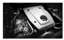
Линейка силовых агрегатов рестайлингового Mitsubishi Pajero Sport третьего поколения состоит из трехлитровой бензиновой «шестерки» мощностью 209 л.с. и турбодизеля объемом 2.4 л мощностью 181 л.с.
