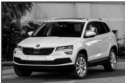
Габаритные размеры компактного Karoq составляют: 4382x1841x1605 мм. Колесная база достигает 2638 мм. Размеры характерные для данного класса автомобилей.
