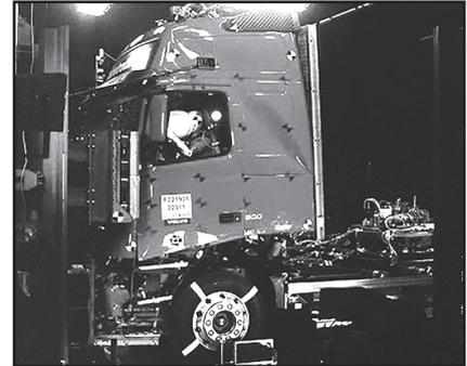
Инженеры компании не обошли стороной и пассивную безопасность грузовика. Каркас кабины сделан из прочнейшей стали, а ударопоглощающие балки и двери выполнены из деформируемого металла. В процессе создания было пройдено несколько тысяч смоделированных и около ста реальных краш-тестов, чтобы Volvo FH по праву назывался самым безопасным грузовым автомобилем в истории.
