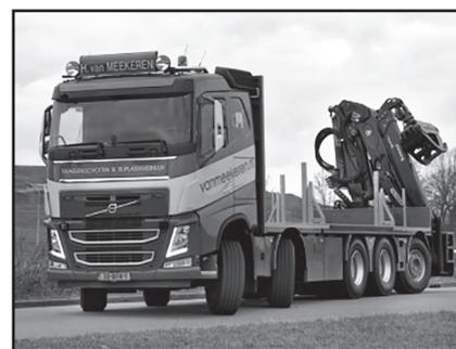
Каждая из модификаций Volvo FH делится на пять грузовых групп: 18.2~21 т (4×2), 26.1~29 т (6×2), 26.5~35 т (6×4), 32~36 т (8×2) и 33~42 т (8×4 и 10×4). Предлагается четыре варианта высоты шасси: сверхнизкое (около 810 мм), низкое (около 850 мм), среднее (около 900 мм) и высокое (около 1000 мм).
